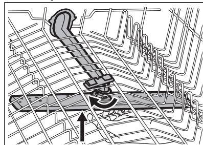
3. Reinig de sproeiarm onder stromend water. Gebruik een smal en puntig gereedschap, bijv. een tandenstoker,
